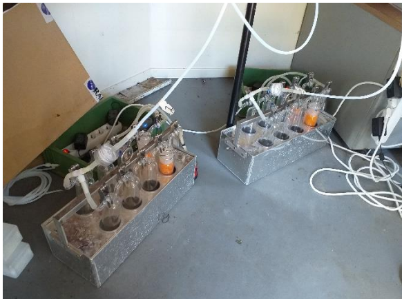
Foto 7. Meetopstelling voor nat-chemie.
