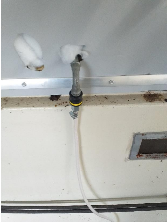
Foto 6. Inlaat van de perslucht voor het opblazen van een rubberen band aan de binnenzijde van de Lindvall-dozen.
