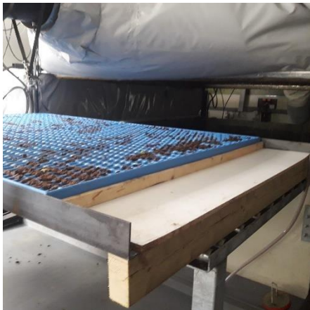
Foto 1. Cattle Floor en stalen oplegprofiel.
