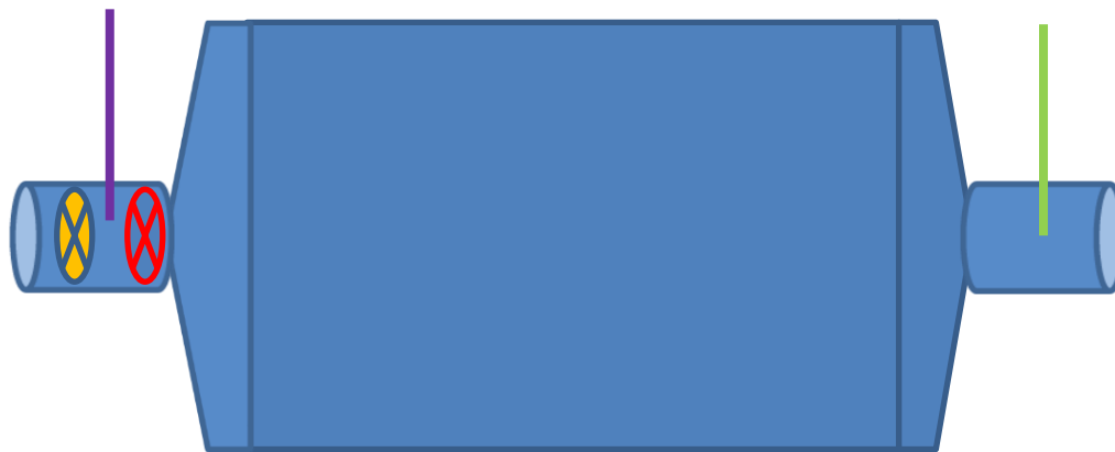
Figuur 1. Schematische weergave Lindvall-doos (bovenaanzicht) met luchtinlaat (rechts) en – uitlaat (links), de meetventilator (rood), de ventilator (geel) in de uitlaat, de monsternamenleiding voor de NH 3 -achtergrondconcentratie (groen) en de gemeten NH 3 -concentratie (paars).
